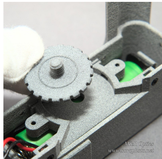
図10 内蓋への固定ねじの設置
