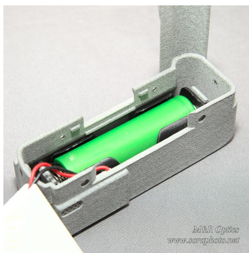
図4 本体への電装部品組み込み
